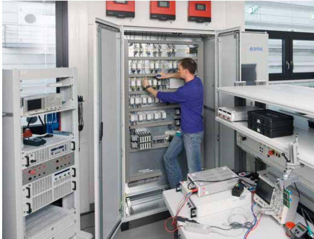
*Labor für Gleichstrom-Netztechnik (am Fraunhofer-Institut für Integrierte Systeme und Bauelementetechnologie). In dem Labor wird das Verhalten lokaler Gleichspannungsnetze und die Integration in bestehende Gebäudeinfrastrukturen untersucht. Durch den Einsatz lokaler Gleichspannungsnetze können elektrische Wandlungsvorgänge vermieden beziehungsweise effizienter realisiert und damit wesentliche Einspareffekte erzielt werden.*
