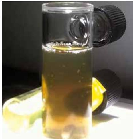
Photokatalytische Wasserstoffherzeugung durch Belichtung von Nanokristallen
