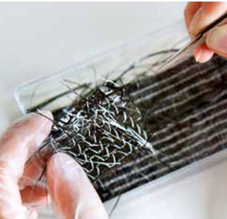
Carbonfasern zur Herstellung von carbonfaser-verstärkten Kunststoffen für den Leichtbau
