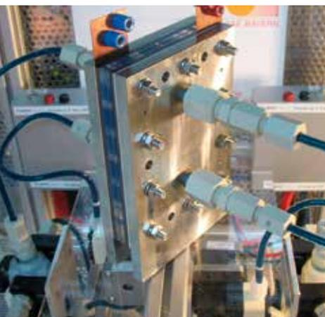
Experimenteller Aufbau zur Untersuchung innovativer Elektrodenmaterialien für Redox-Flow-Batterien
